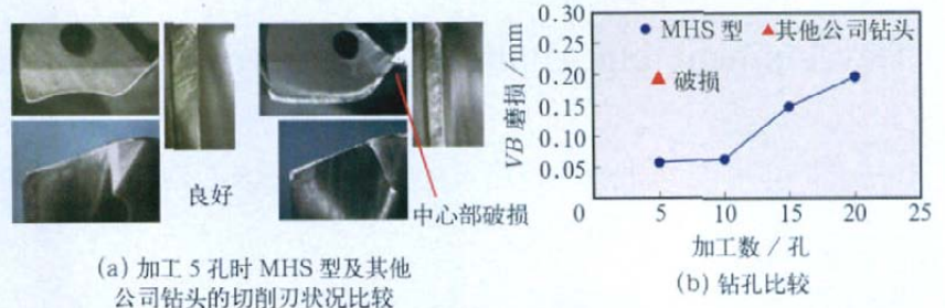
图9 MHS钻头高硬模具钢加工示例
